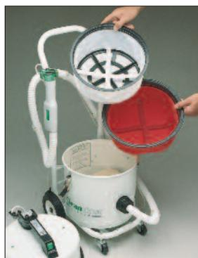
El sistema de filtración de cuatro fases está compuesto por una bolsa colectora desechable y fácil de cambiar, dos filtros de paño y un microfiltro. El microfiltro retiene el 99,997% de todas las partículas de polvo de más de 0,5 micrones.
